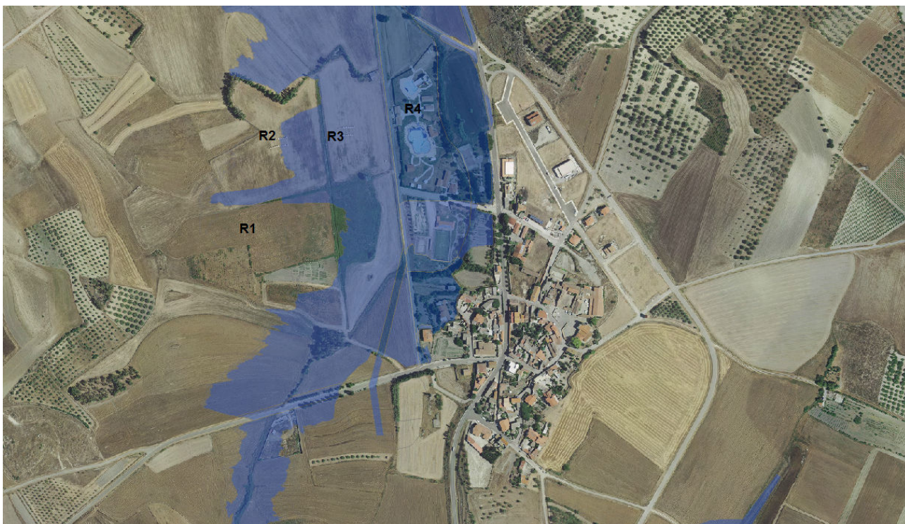
Figura 12: rischio idraulico di tipo R3 ed R4 nel centro urbano
